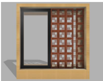
ภาพที่ 12 โครงผนังเสริมประตูขนาด 2.10 x 2.00 เมตร
